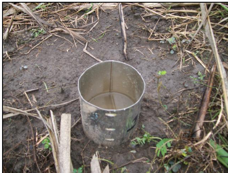
Figura 3. Pluviómetros. Ingenio La Troncal
