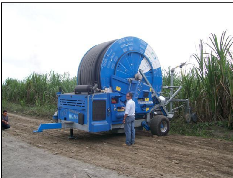
Figura 1. Enrollador OCMIS VIR-7 ®. Ingenio La Troncal
