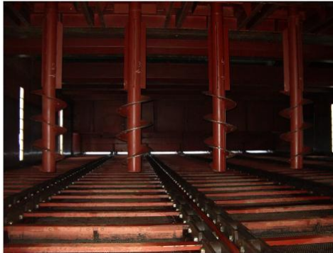
Figura 4a. Vista interna de un difusor de fondo fijo tipo BMA.
